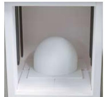
Storta a tenuta di gas con fornitura gas attraverso il fondo del forno
