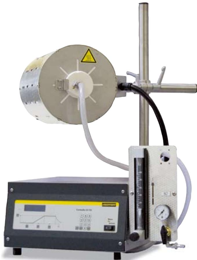
RT 50-250/11 con sistema di fornitura gas per l'azoto
