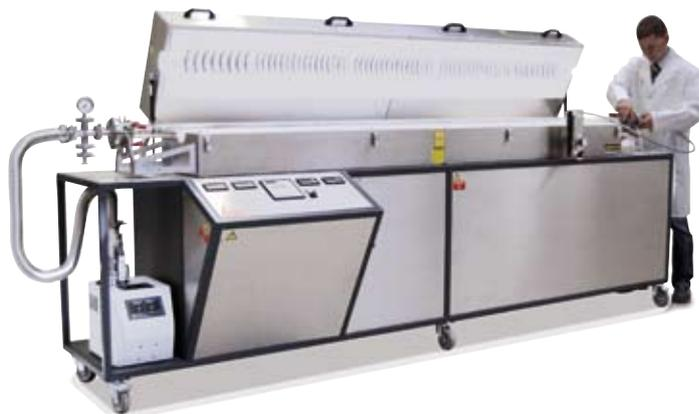
RS 80/2350/11S con tubo di vetro al quarzo di lunghezza speciale, possibilità di gas inerte e di depurazione
