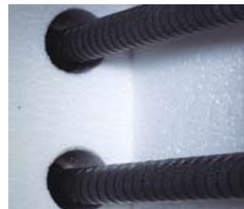
Camera forno con materiale in fibra pregiato e barre di riscaldamento SiC ai due lati
