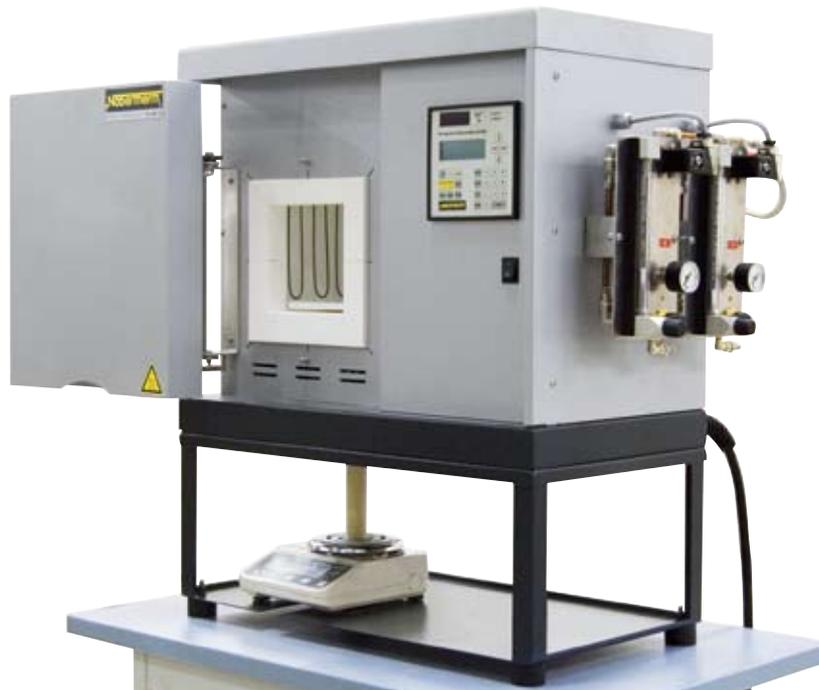
LHT 04/16 SW in versione personalizzata con bilancia per determinare la perdita di peso e sistema di fornitura gas
