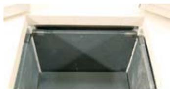
Vano forno S 73/HS rivestito con piastre in SIC
