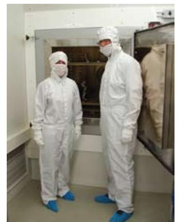
Forno a convezione N 250/65HAC con camera bianca. Per il caricamento del forno la porta si trova nella camera bianca, classe 100, la camera del forno si trova nella camera grigia posteriore.
