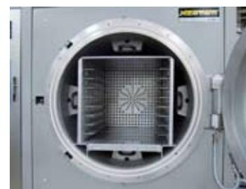
Contenitore di processo con riscaldamento interno
