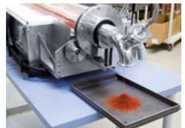
Alimentazione del gas inerte all'uscita del tubo
